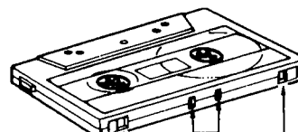
Trous de détection d'une bande métal
