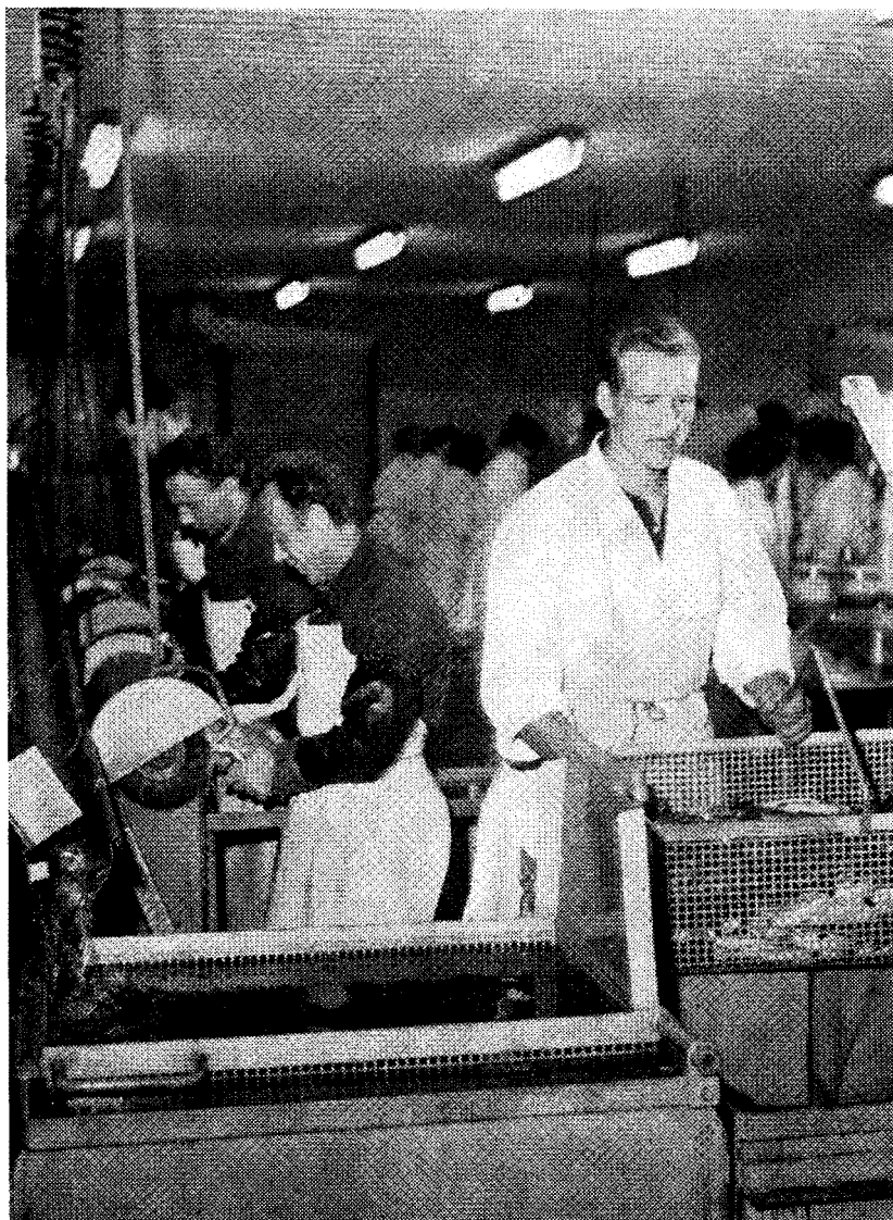
Fig. 50 Rensning af ørreder til indfrysning. ●p- skæring og udtag- ning af indvolde og gæller sker ved bor- det i lokalets midte. Nyrerne fjernes på de roterende børster til venstre i forgrun- den (D. A. Ø., Brande).
