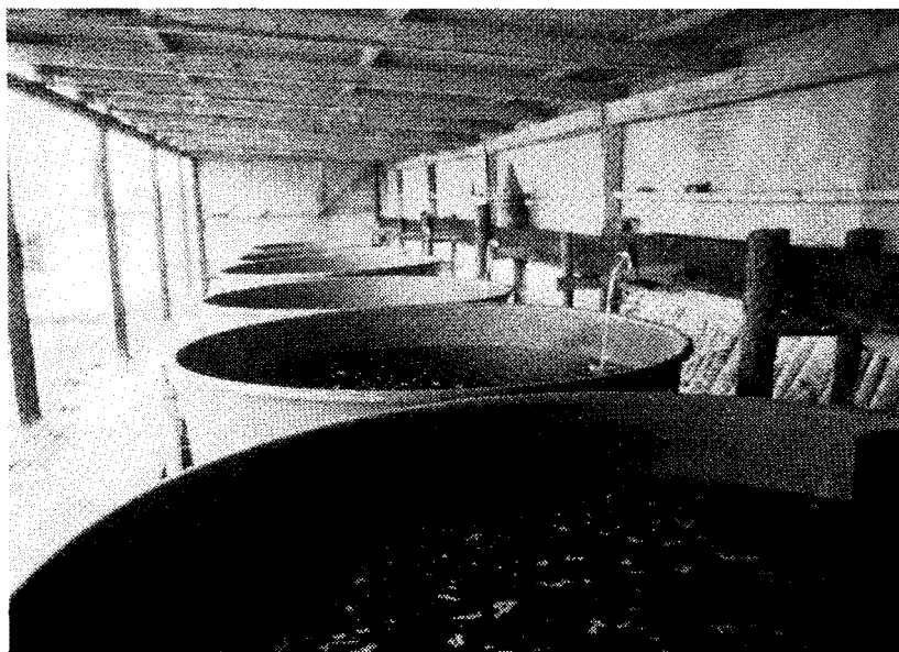
Fig. 32 Cirkulære glasfiber- bassiner til opdræt af ørredyngel. Dia- meter 2 meter, dyb- de 55 cm.
