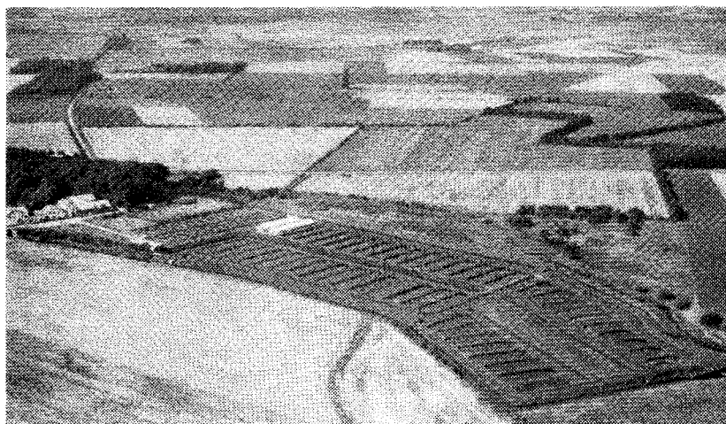
Fig. 54 Luftfotografi af forsøgdambruget. I nederste højre hjørne ses fisketrappen, der er sammenbygget med stemmeværket. Bag produktionsdammene og de to bassinhuse ses de små forsøgdamme. Bygningerne i baggrunden rummer laboratorium, kontorer, akvarieanlæg og beboelse.
